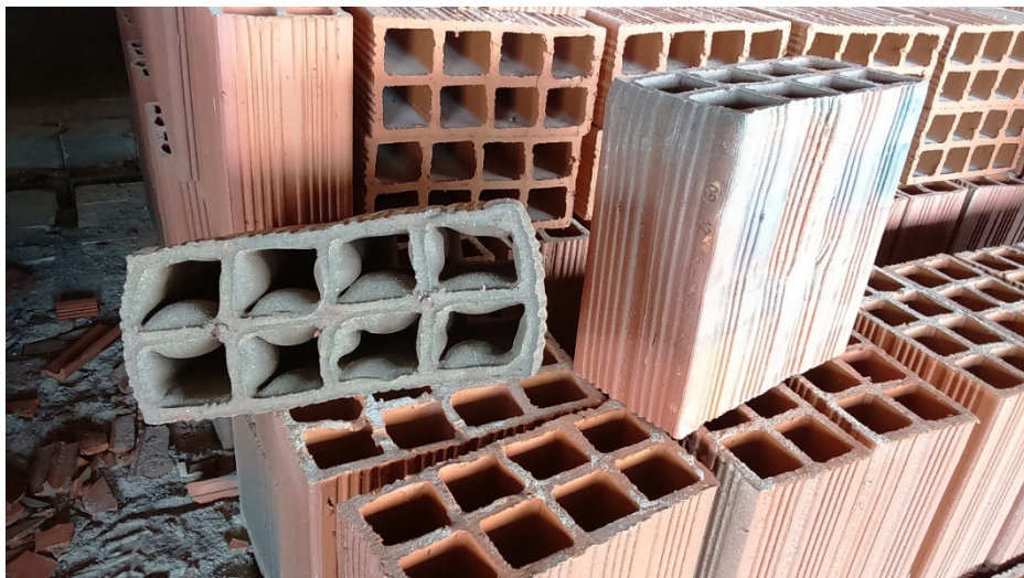
Figura 7 – Tijolo defeituoso, com problema na queima.
