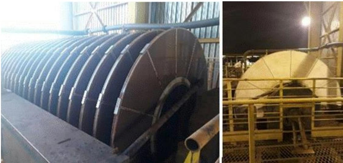
**Figura 4.** Filtro de rejeito antes da regeneração (à esquerda) e após regeneração (à direita).
