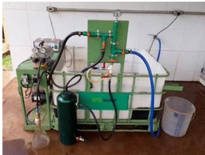
**Figura 9.** Sistema piloto de regeneração química de placas cerâmicas
