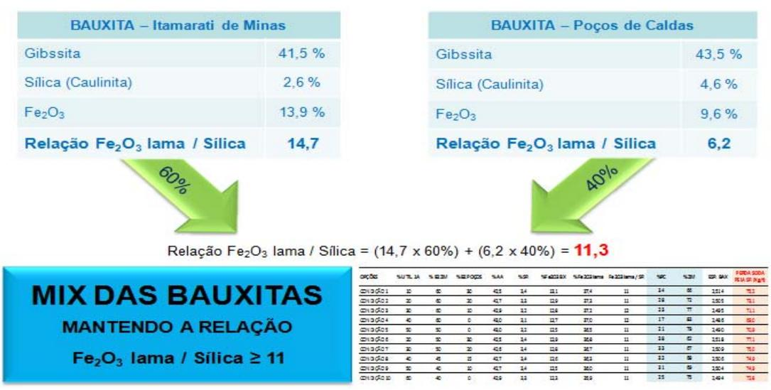
Figura 13. Ferramenta de simulação e definição de blendagem da bauxita. Fonte: VM\_CBA
