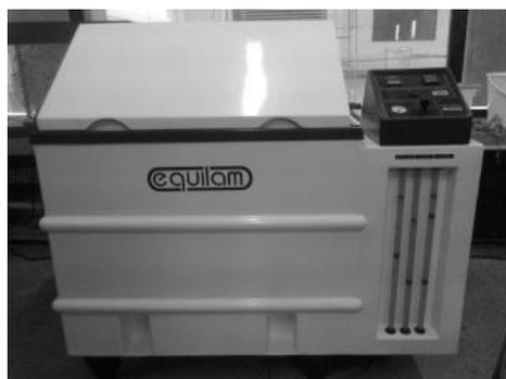
**Figura 2.** Equipamento de névoa salina.
