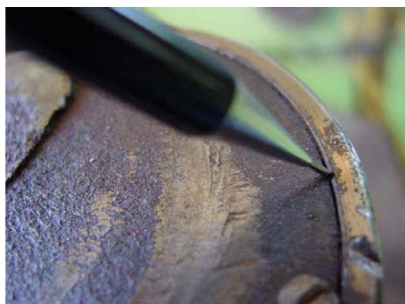
**Figura 2:** Vista da seção de fratura, com detalhe da bucha e raio de adoçamento interno.
