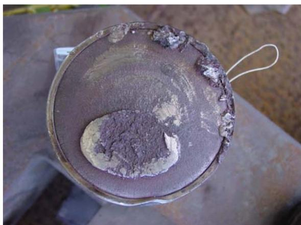
**Figura 1:** Vista da seção de fratura, mostrando o embuchamento.
