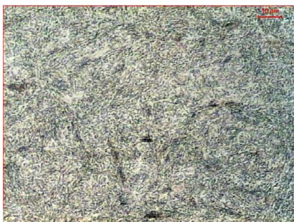
**Figura 4:** Microestrutura do aço AISI/SAE 1080. Direção longitudinal. Reativo Nital. MO 1.000X.
