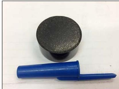
**Figura 4.** Amostra de pó de hematita embutida a quente com baquelite para observações em MEV.
