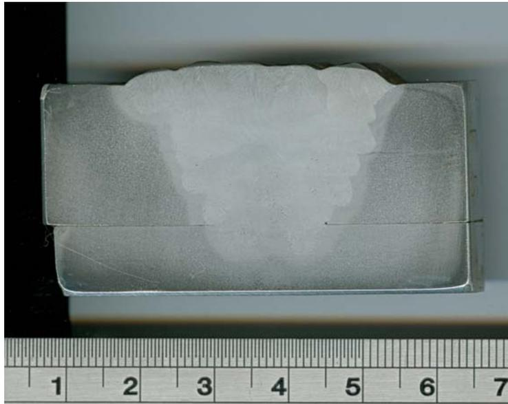
**Figura 5.** Aspecto macrográfico das juntas soldadas.
