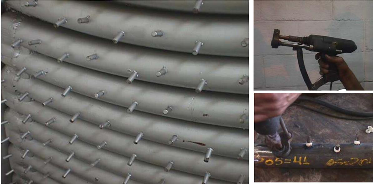
Figura 5. Sistema de pinagem para retenção de escória.
