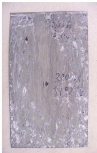
(a) 80/20 Sn/Zn sem passivação (3  $\mu\text{m}$ )
