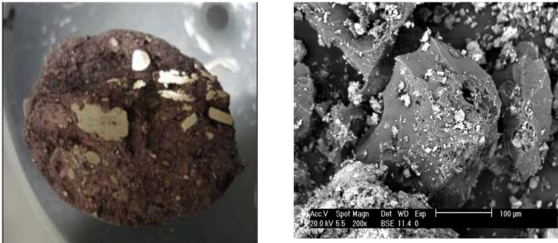
Figura 4 – Detalhamento da análise via MEV do briquete - Partículas de coque
