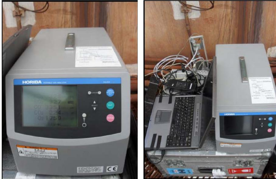
Figura 1. Analisador de gases PG-250.
