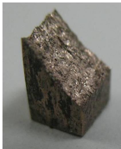
**Figura 3.** Curva tensão x compressão com velocidade de 0,1 mm/s e parte do corpo de prova após ensaio.
