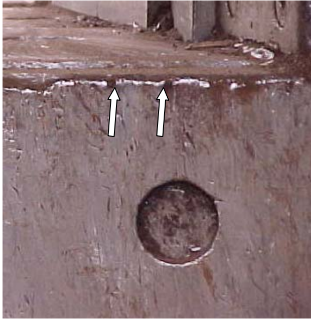
Figura 7. Aço S1 com pequenas quebras no gume de corte.
