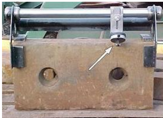
Figura 4. Instrumento para medição de desgaste das navalhas e seu posicionamento durante a utilização.
