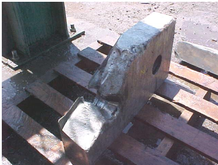
Figura 11. Navalha de aço S1 com 56 HRC após 4h de operação.
