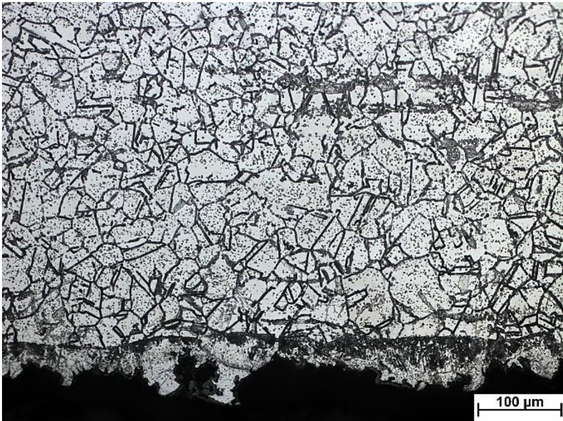
Figura 1. Micrografia obtida por meio de microscópio óptico evidenciando a precipitação de carbonetos na amostra. Aumento de 200x.
