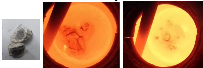
**Figura 5** – Partícula de Cal 60% CC; logo após a adição na escória e após 1 minuto de teste.
