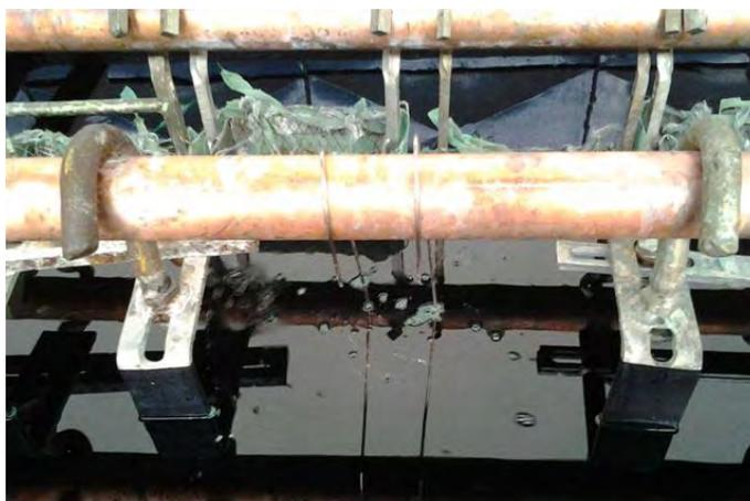
**Figura 1.** Configuração do sistema experimental de niquelagem do substrato de aço ASTM SA 516 Gr. 70.
