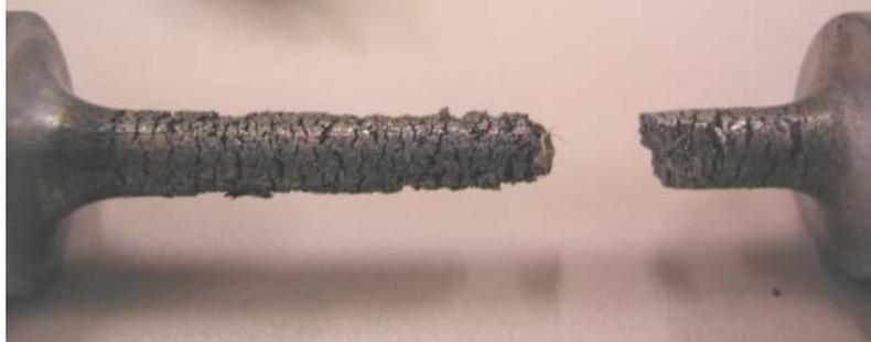
**Figura 4** - Corpo-de-prova de aço AISI 304 trincado por CSTF (carga constante) em meio contendo HCl ( $\text{pH} \approx 0,0$ ); temperatura ambiente.
