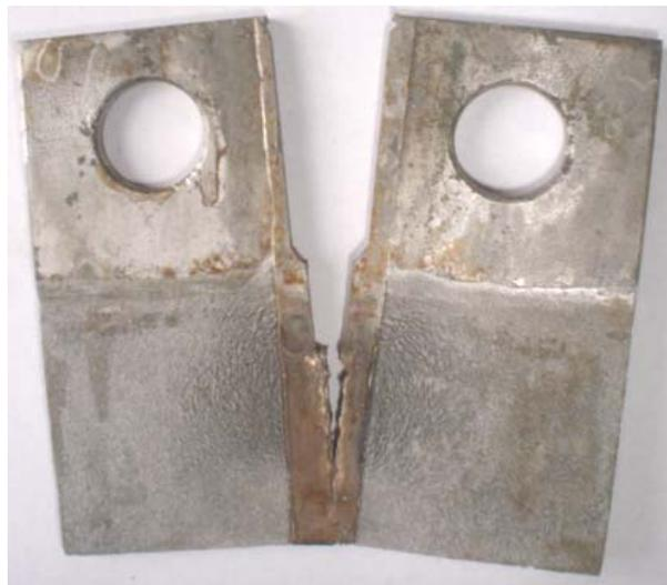
**Figura 5** - Corpo-de-prova do tipo tração-compacto de aço AISI 409 soldado com metal de adição de aço AISI 308L, trincado por CST na região da zona fundida; meio contendo HCl ( $\text{pH} \approx 0,0$ ); temperatura ambiente.
