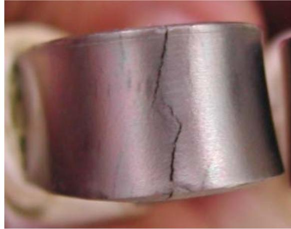
**Figura 1** - Trincamento por corrosão sob tensão em CP em U; aço SAF 2205, deformação constante; 42% MgCl<sub>2</sub> (143°C); 120h.
