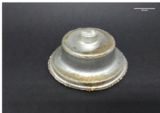
**Figura 01.** Amostra da liga AA2618 na condição de forjada
