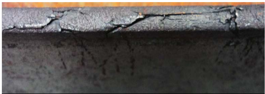
Figura 3. Amostra de Perfil I 6'' (a) com defeito de trincas a quente nas abas paralelas. (b) Aspecto macrográfico do mesmo (Corrida 1_53680).
