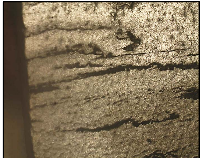
Figura 4. Amostra de Perfil I 6'' com defeito de trincas a quente nas abas e aspecto macrográfico do mesmo (Corrida 1_67645).
