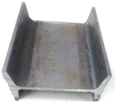
Figura 3. Amostra de Perfil I 6'' (a) com defeito de trincas a quente nas abas paralelas. (b) Aspecto macrográfico do mesmo (Corrida 1_53680).
