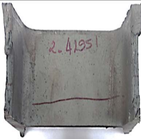
Figura 4. Amostra de Perfil I 6'' com defeito de trincas a quente nas abas e aspecto macrográfico do mesmo (Corrida 1_67645).
