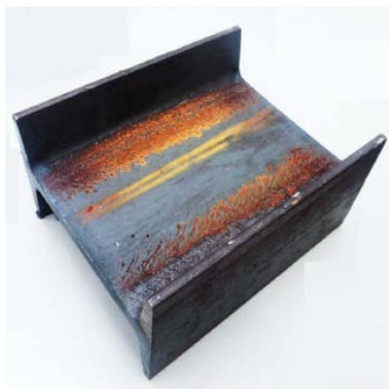
Figura 4. Amostra de Perfil I 6'' com defeito de trincas a quente nas abas e aspecto macrográfico do mesmo (Corrida 1_67645).
