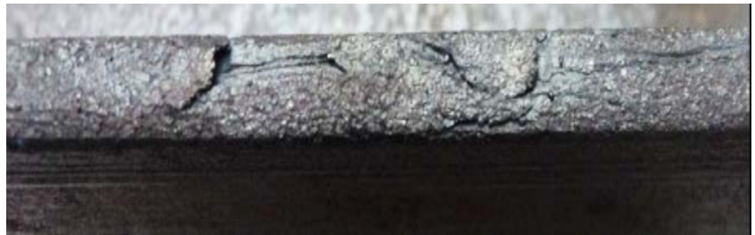
Figura 3. Amostra de Perfil I 6'' (a) com defeito de trincas a quente nas abas paralelas. (b) Aspecto macrográfico do mesmo (Corrida 1_53680).
