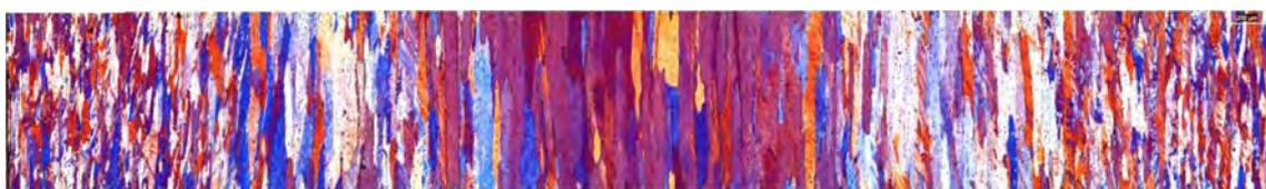
**Figura 5** - Macrografia com luz polarizada do lote 3 no início do bobinamento no laminador a quente.
