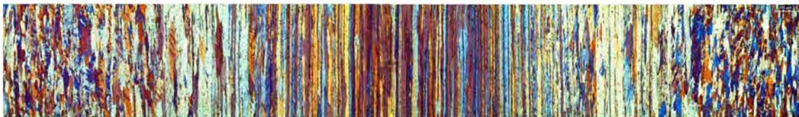
**Figura 8-** Macrografia com luz polarizada do lote 4 no final da bobina no laminador a frio.
