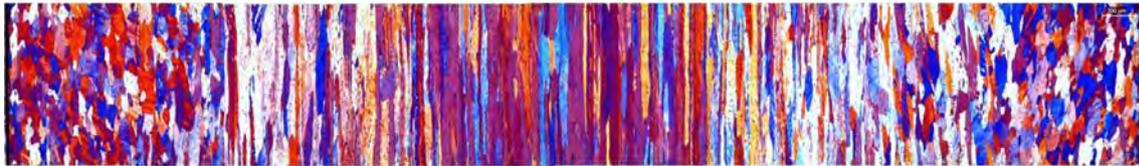
**Figura 6-** Macrografia com luz polarizada do lote 3 no final da bobina no laminador a frio.
