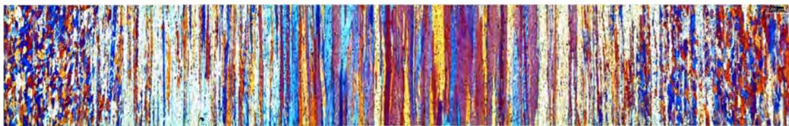
**Figura 1** – Macrografia com luz polarizada do lote 1 no início do bobinamento no laminador a quente.
