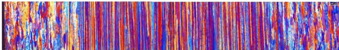
**Figura 2**- Macrografia com luz polarizada do lote 1 no final da bobina no laminador a frio.
