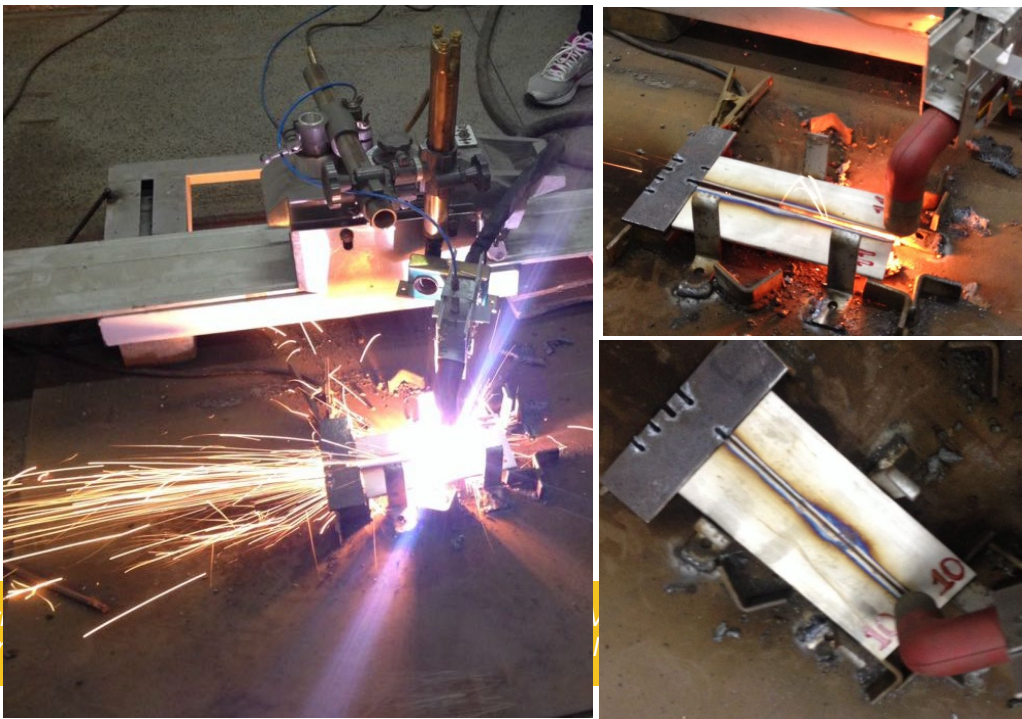
Figura 3. Percurso da tocha a plasma indicando os lados 1 e 2 formados após o corte.
