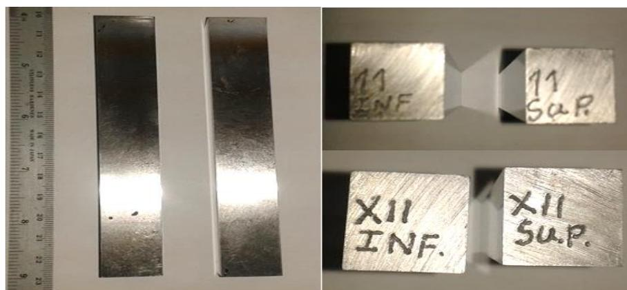
**Figura 1.** Corpos de prova para caracterização das propriedades físicas e estudos dos defeitos.
