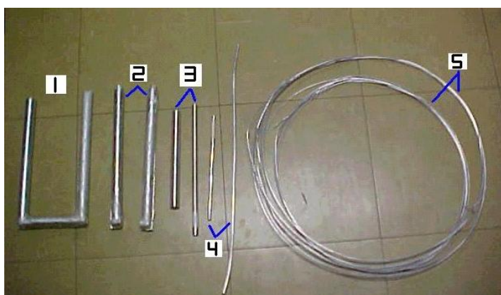
Figura 2. Seqüência alto explicativa das etapas operacionais até a obtenção do diâmetro de 3,45mm desejado.
