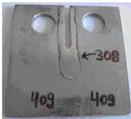
**Figura 10.** CP tração-compacto, metal base (incluindo a zona de ligamento) de aço AISI 409, metal de enchimento de aço AISI 308.
