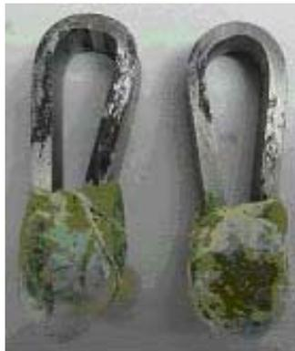
**Figura 3.** Corpos-de-prova de aço inoxidável ferrítico (AISI 439) soldado com metal de enchimento de aço inoxidável austenítico (AISI 308); em soluções aquosas contendo 42% $MgCl_2$  ( $143^\circ C$ ); não ocorreu trincamento durante aproximadamente 200 horas de ensaio.
