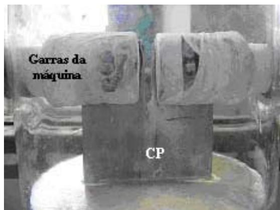
**Figura 4.** CP do tipo tração-compacto, de aço AISI 409 soldado com aço AISI 308, sendo ensaiado em soluções aquosas contendo 42% $MgCl_2$  ( $143^\circ C$ );  $K_1 = 68 \text{ MPa}\sqrt{m}$ .
