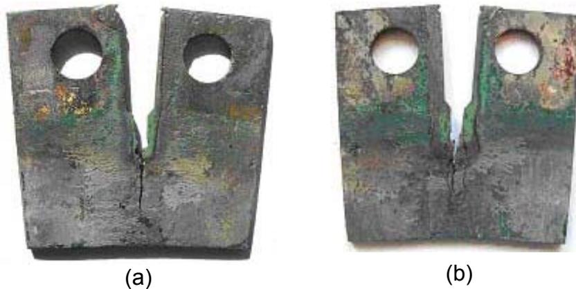
**Figura 11.** Corpos-de-prova correspondentes à Figura 10 ensaiados sob tensão; carga constante; nota-se que os trincamentos ocorreram nas regiões austenítica (ZF) e ferrítica (zona de ligamento do CP); soluções aquosas contendo 42%  $MgCl_2$  ( $143^\circ C$ ).
