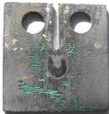
**Figura 12.** Corpo-de-prova correspondente à Figura 11 ensaiado sob tensão; neste caso o CP não sofreu CST, mas sim ataques na região ferrítica (MB e ZTA), principalmente, na zona de ligamento do CP; soluções aquosas contendo 42%  $MgCl_2$  ( $143^\circ C$ ).
