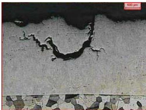
**Figura 7.** Fotomicrografia de um CP trincado por CST. Nota-se que a trinca principal está na região do aço inoxidável austenítico (cordão de solda). Reativo: Vilela.
