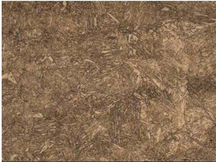
**Figura 5.** Micrografia do material identificado por Q&P4, austenitizada a 870°C por 300seg, seguido de têmpera em banho metálico a 147°C e finalmente tratamento de partição a 350°C por 100 segundos. Seção longitudinal. 500X.
