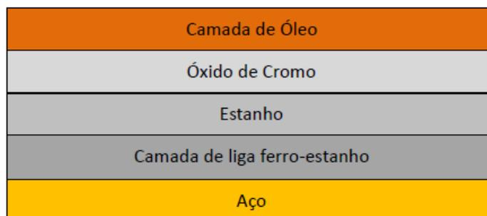
**Figura 5.** Modelo de Camadas usado para modelagem no Elipsômetro do filme fino de óleo em folha-de-flandres.
