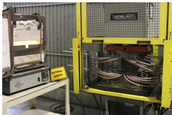
**Figura 2.** Prensa com matriz e molde refrigerados a água e forno tipo mufla utilizados para o processo de estampagem a quente piloto.
