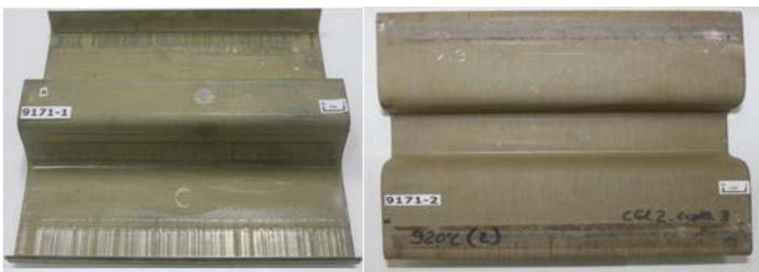
**Figura 8.** Aspecto da amostra após o processo de conformação a quente em escala piloto.
