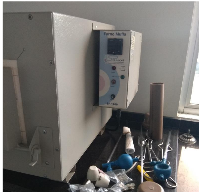
Figura 2. Forno do tipo Mufla com atmosfera protetora de Nitrogênio. Fonte: (AUTOR, 2019).
