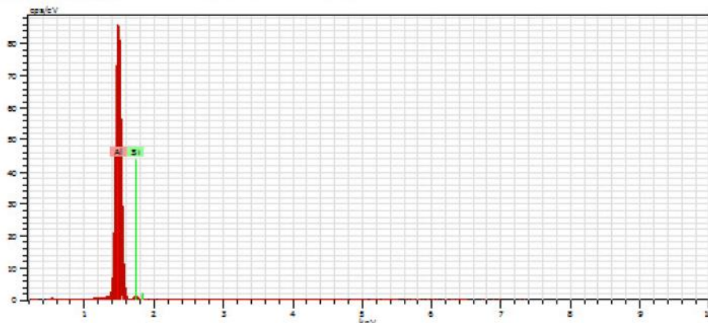
Figura 33 – EDS da liga AA4XXX com 5% de silício processada por MAE durante 60 minutos
