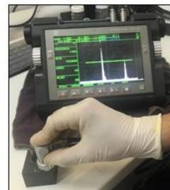
Figura 3 – Calibração do aparelho krautkramer no bloco de carbeto de tungstênio.
