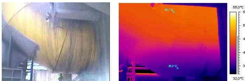
**Figura 2.** Acúmulo de material na linha de saída dos exaustores de COG.
