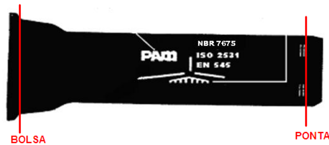
Figura 1. Regiões de Bolsa e Ponta do tubo para retirada de amostras para o presente estudo.
