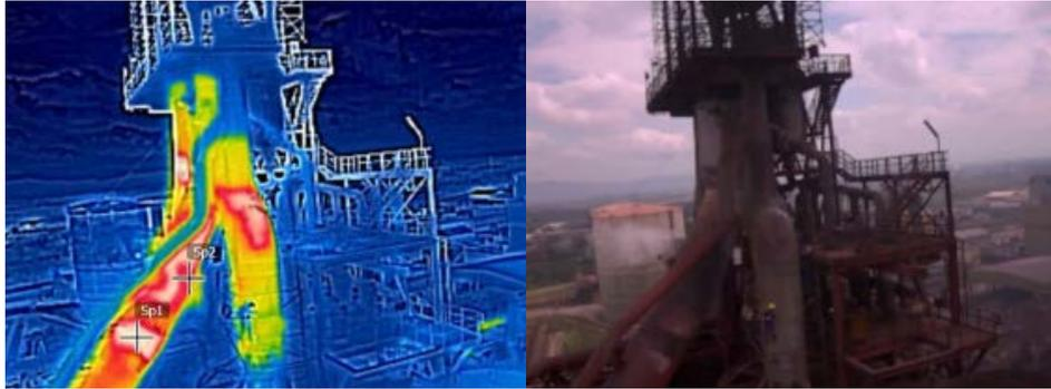
**Figura 21** – Degradação dos refratários nas curvas da instalação
