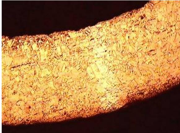
**Figura 8** – Estrutura da fita laminada utilizada no tubo soldado
