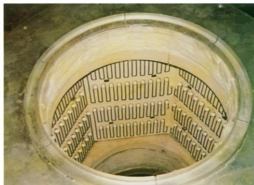
**Figura 3** – Exemplo de forno tipo poço.
