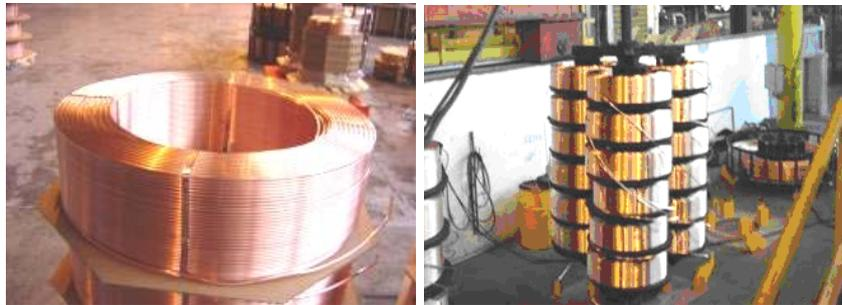
**Figura 4** – Exemplo da bobina de tubo de cobre e da carga preparada para recozimento.
