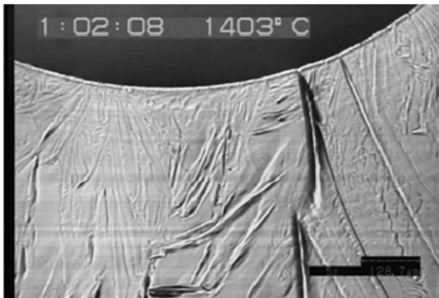
Figura 7. Transformação de tipo massivo de ferrita \delta a austenita em um aço de 0,08%C; 1,6%Mn; 3%Si e 0,012%Ti. Velocidade de resfriamento 5 o /min. Observação em microscópio confocal de varredura a laser. (7)
