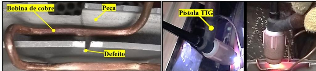
Figura 3. Soldagem com pré-aquecimento
