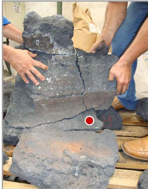
**Figura 10.** Região da linha de gusa onde foi retirada a amostra para estudo.
