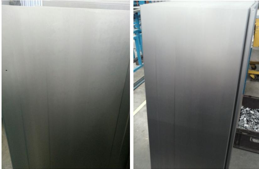
**Figura 6.** Porta de refrigerador produzida com o material CSN LB 60.
