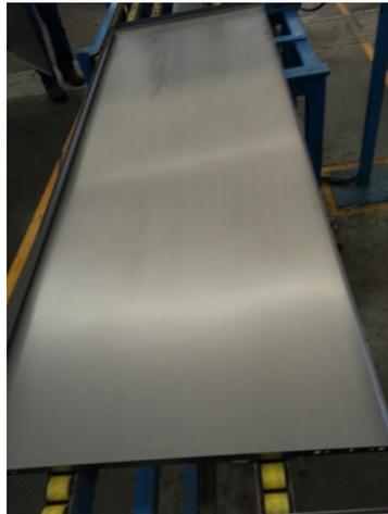
**Figura 7.** Lateral de refrigerador produzida com o material CSN LB 65.
