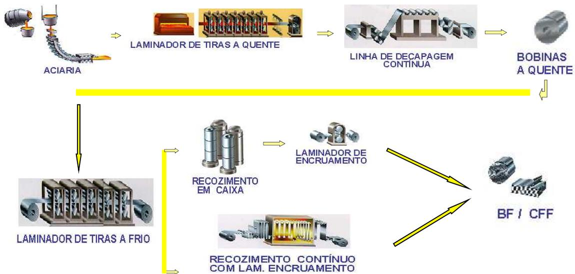
**Figura 2.** Fluxos de produção CSN disponíveis para a produção de aço laminado a frio para Refrigeração.
