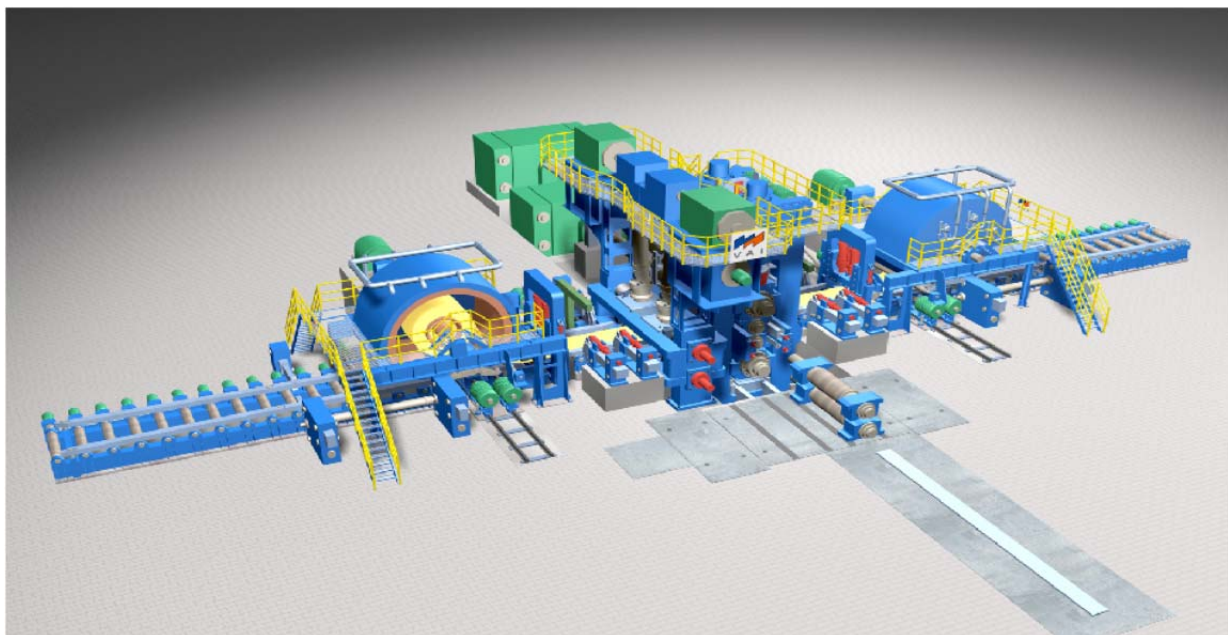
Figura 2 – Esquemático do laminador de tiras a quente do tipo Steckel.
