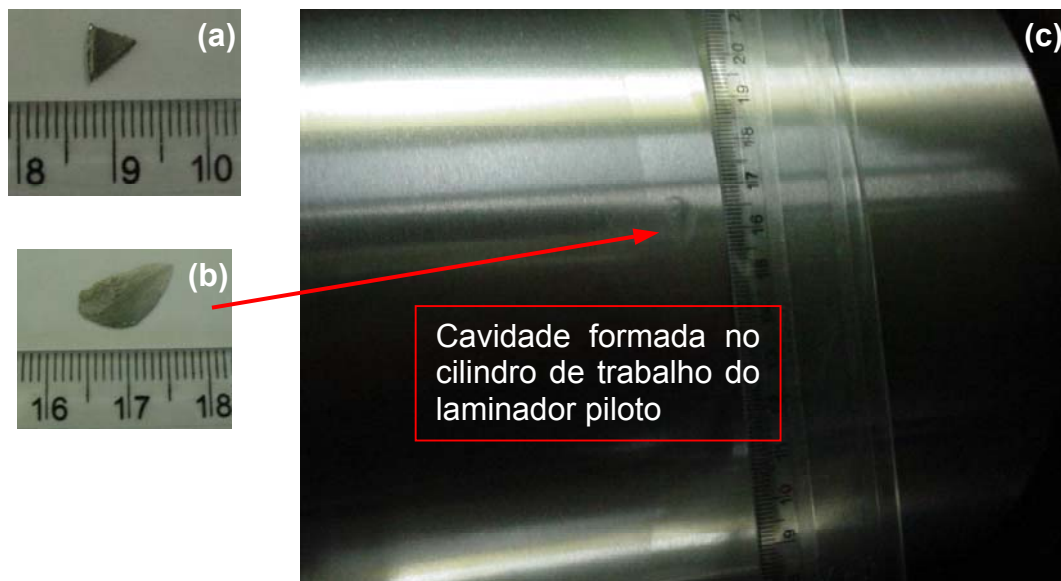
Figura 9 – Esquema mostrando a partícula que foi inserida entre os cilindros de laminação do laminador piloto (a) antes e (b) após a deformação. (c) Quadro de um filme feito para desenvolvimento do trabalho em laboratório mostrando a cavidade formada no cilindro.
