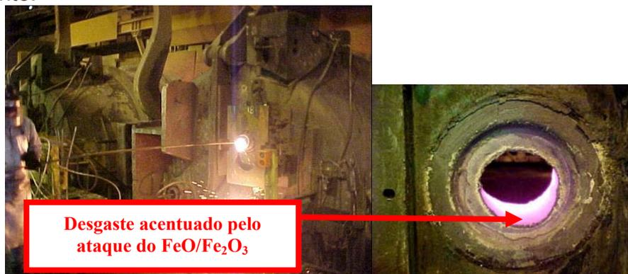
Figura 5. Desgaste da parede interna da válvula superior.
