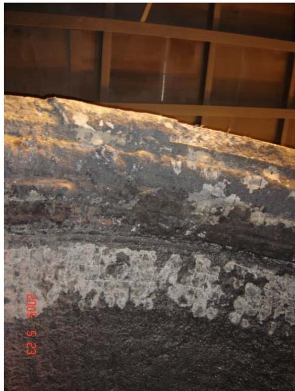
**Figura 4.** Panela em fim de campanha com tijolos com chapeamento metálico.
