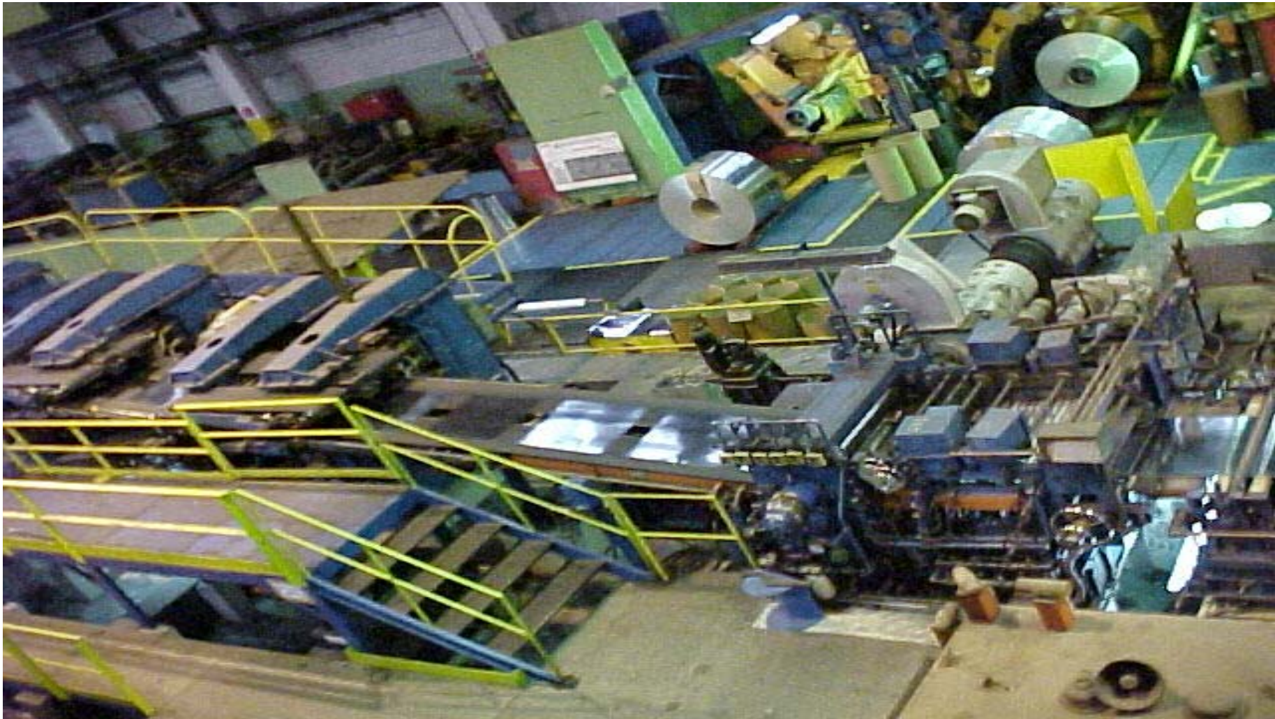
Fig 12 – LEE-1 – Vista parcial da seção de corte. A direita o conjunto Tesoura e desempenadeira e a esquerda o classificador Note as chapas cortadas sobre a correia que leva da saída da tesoura para o classificador.
