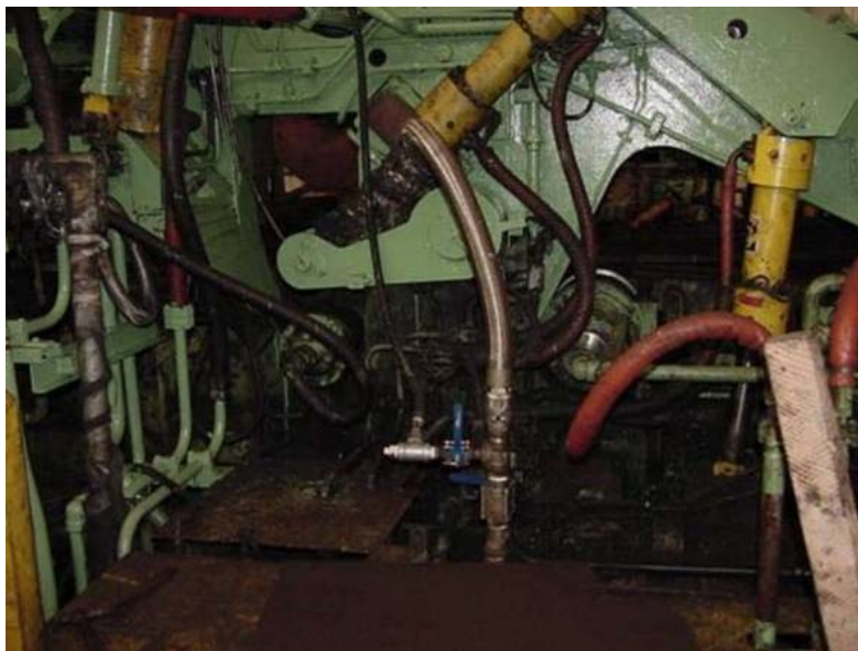
Montadas mangueiras com engate rápido para troca rápida
