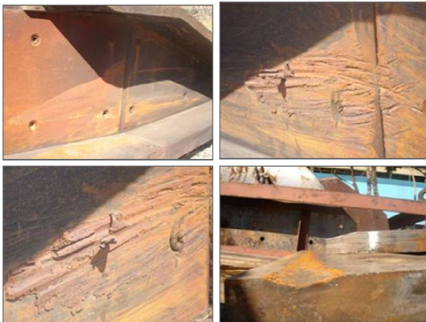
Fonte: Gerência de Manutenção Mecânica do Laminador – IAMT/ ArcelorMittal Tubarão. Figura 18. Desgaste dos liners e material agregado aos mesmos.
