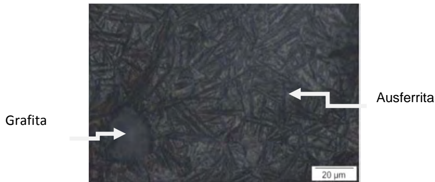
Figura4. Microestrutura do ferro fundido nodular austemperado.
