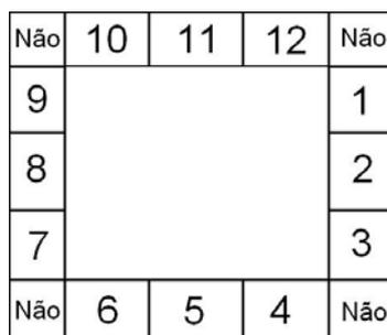
**Figura 3.** Esquema de corte de amostras de seções transversais de tarugos do aço SAE1070.
