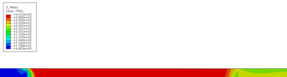
**Figura 13.** Distribuição de tensões de von Mises dentro do arco de contato.
