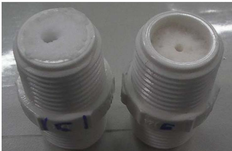
Figura 8. Ensaio de desgaste das ventaneiras (antes a após ensaio).
