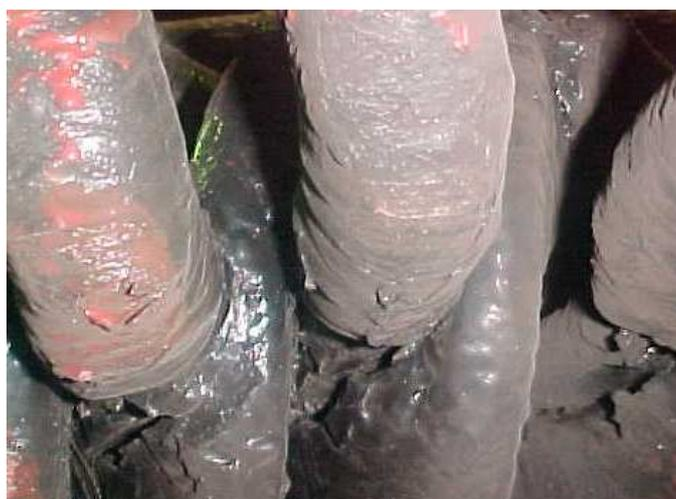
**Figura 2** – Foto do isolante das bobinas com ressecamento aparente.
