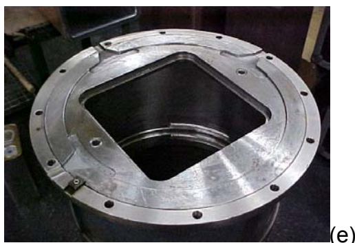
Figura 3. Etapas de preparação do molde para posicionamento dos termopares: (a) usinagem, (b e c) detalhe dos sulcos para passagem dos termopares, (d) terminais para acoplamento entre os termopares e os cabos de compensação, (e) sistema completo do molde.
