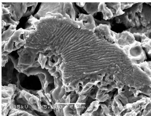
Figura 12 – Imagem da perlita com um aumento de 5000 vezes após 1h de cavitação.
